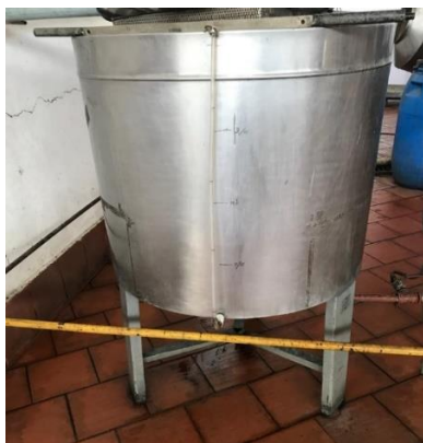
Tanque de bombeo de jugo de caña
